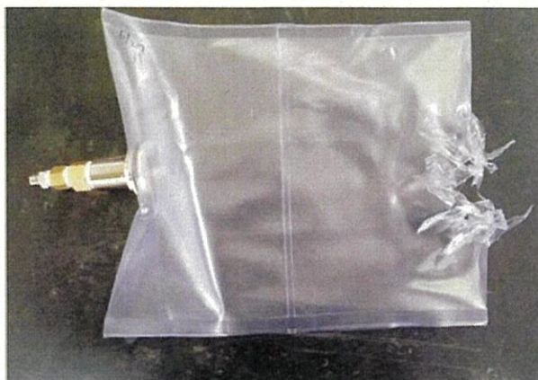
図 7.1.2-5 破裂状態の例 No. 9 (放射状)
