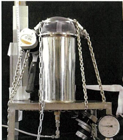
図 7.1.2-11 樹脂製の袋の膨張の様子と破損状態 No. 5 (直線)
