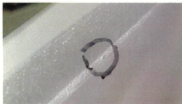
図 7.1.2-7 破裂状態の例 No. 11 (穴)
